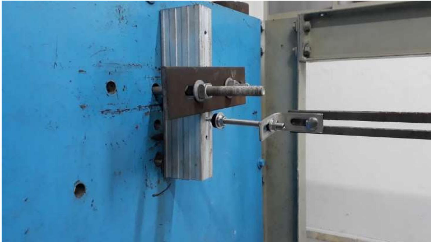
**Ensaio de ancoragem de haste para estrutura metálica de espessura de 0,8mm**
