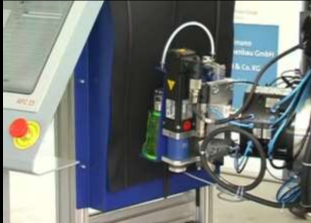
Cabeçote de costura 3D desenvolvido no projeto LEAPFROG
