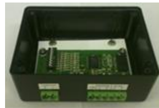
Montagem do IL em Caixa Plástica Comercial
