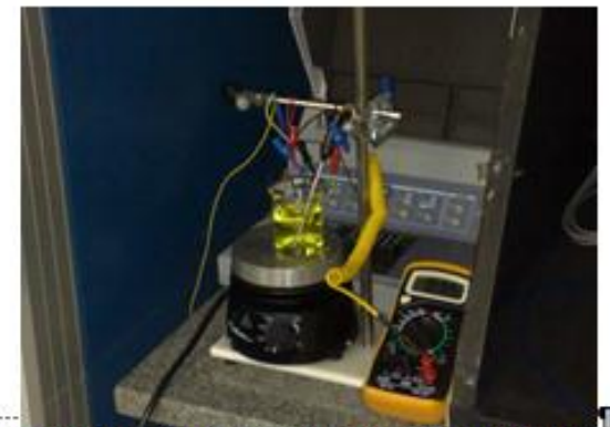
Figura 2 – Protótipos de ISFETs com filmes sensíveis de nitreto de silício e nitreto de alumínio e encapsulamento polimérico, bem como setup de caracterização dos mesmos.
