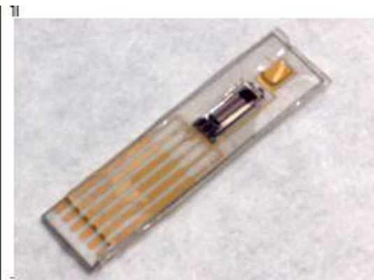
Figura 2 – Protótipos de ISFETs com filmes sensíveis de nitreto de silício e nitreto de alumínio e encapsulamento polimérico, bem como setup de caracterização dos mesmos.
