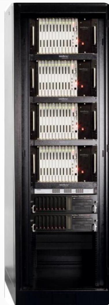
**Configuração máxima:** 8 Troncos Analógicos, 4 Troncos Digitais (E1), 60 Troncos IP (SIP), 640 Ramais TDM , 500 Ramais IP (SIP)
