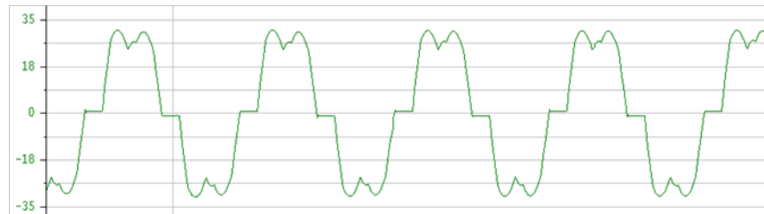
Forma de onda da corrente de alimentação 0,5 seg após a partida
