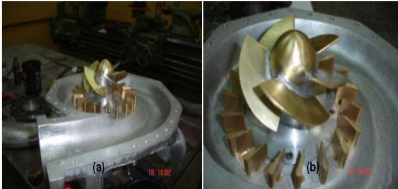
Figura 4 - Modelo da turbina (a) e detalhe do rotor (b).
