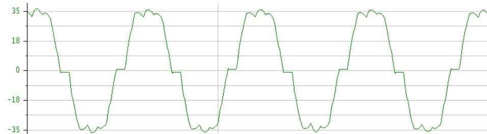
Forma de onda da corrente de alimentação **1,5 seg** após a partida
