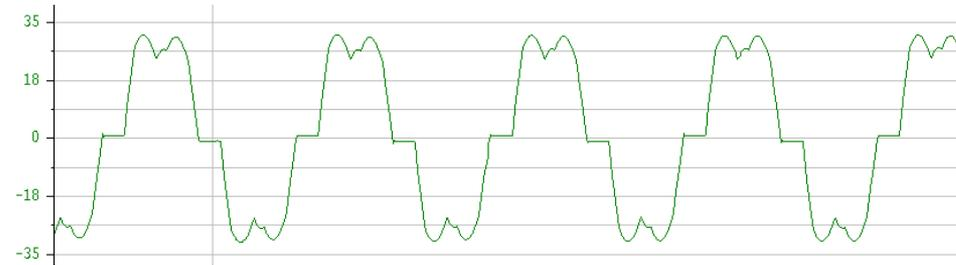
Forma de onda da corrente de alimentação **0,5 seg** após a partida
