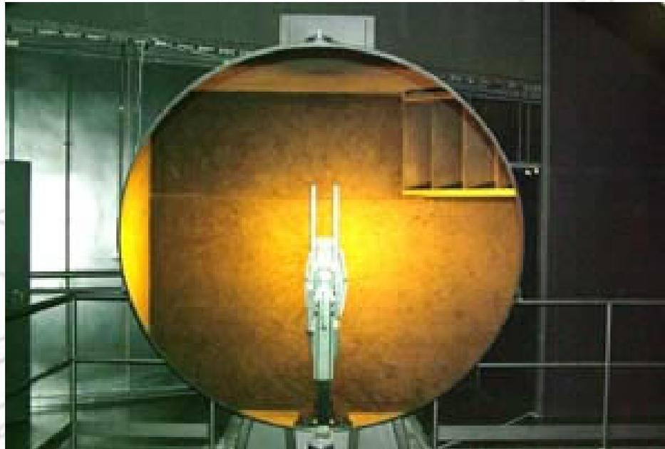
**Fotogoniômetro – Aparelho para medição de fluxo luminoso e distribuição de intensidade de luz**
