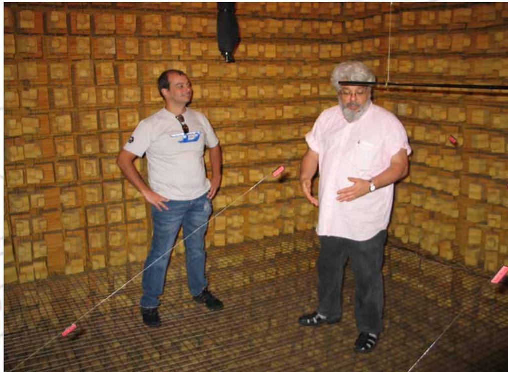
**Câmara Anecóica – Aparato para desenvolvimento de modelos de medição acústica**
