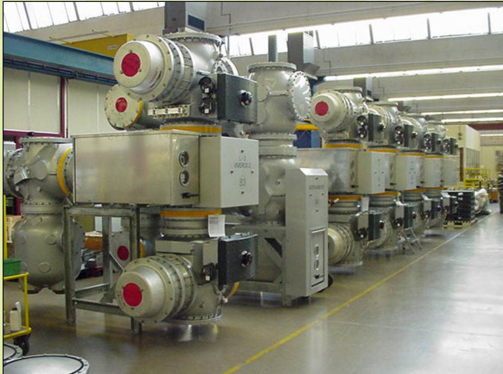
72,5kV - Arranjo Barra Dupla (abrigada)
