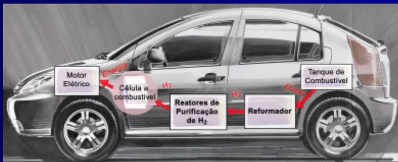
Esquema de um sistema de célula a combustível do tipo membrana trocadora de prótons (PEMFC) em automóvel
